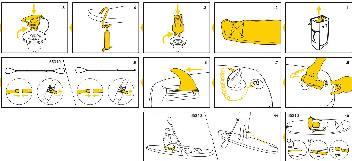
ملاحظة: ينفير مقابس ضغط الهواء للمضخة اليدينية ضغط الهواء أعلى من 5 أرطال لكل بوصة مربعة، وهو أمر طبيعي. عندما يكون ضغط الهواء في المنتج أقل من 5 أرطال لكل بوصة مربعة، فلن يظهر مقابس ضغط الهواء قيمة.
